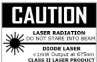
Rayo láser visible. **No mire directamente al rayo láser** para evitar lesiones en los ojos. Aparato con láser de clase 2.
