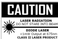
Zichtbare laserstraal. Kijk niet in de laserstraal om oogletsels te voorkomen. Dit toestel is een laserproduct klasse 2. Uitgangsvermogen < 1 mW, golflengte 635 ~ 660 nm.
