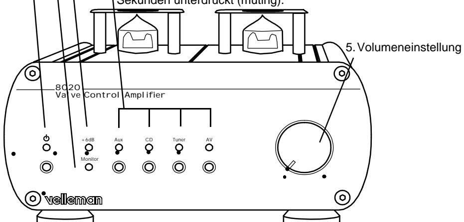
☞ Die +6dB-Funktion kann auch verwendet werden, um den Niveauunterschied zwischen den verschiedenen Quellen abzustimmen. So werden Sie beim Umschalten zwischen den verschiedenen Quellen keine plötzlichen Volumenunterschiede feststellen.
