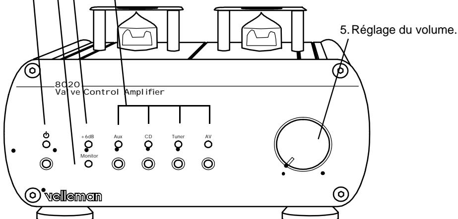
☞ La fonction +6dB peut être utilisée pour ajuster la différence de niveau entre les différentes sources. Ainsi, vous n'observerez pas de différences de volume soudaines lors du passage d'une source à l'autre.
