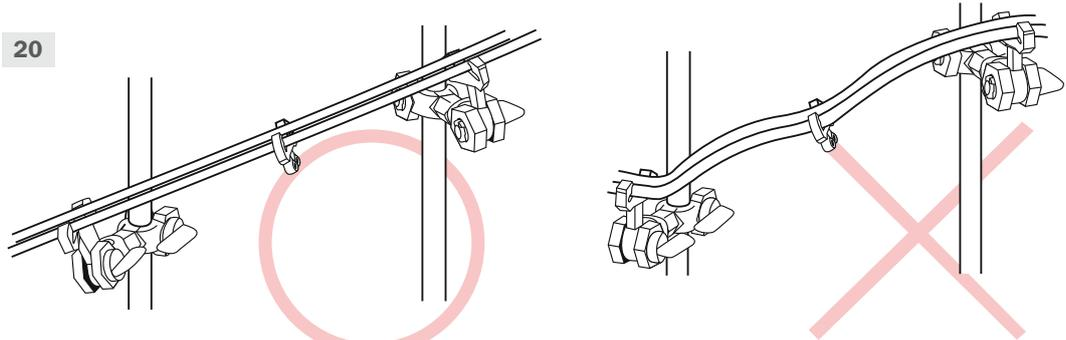
Erzeugen Sie ein Gefälle durch ein Versetzen der Arme
