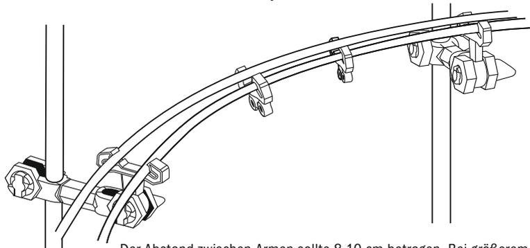
Der Abstand zwischen Armen sollte 8-10 cm betragen. Bei größerem Abstand muss eine Schienenhalterung [A6] montiert werden
