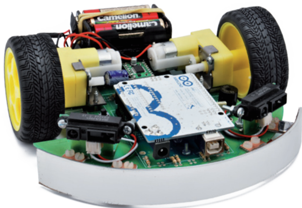
Il robot dotato di paraurti anteriore in lamina d'alluminio.
