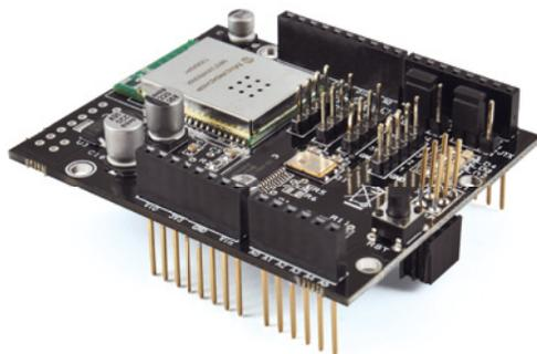
circuito è a 3,3V, ottenuti mediante un riduttore di tensione alimentato dalla linea 5V di Arduino.
