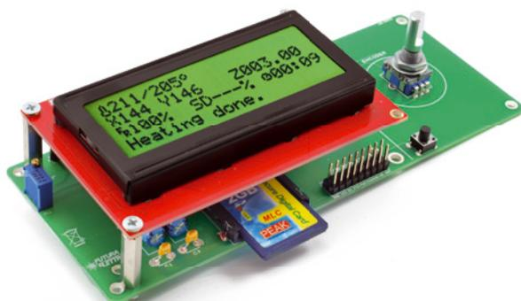
ponenti di tipo tradizionale. I componenti sono pochi e non ci sono particolari difficoltà nel montaggio, in ogni caso è meglio partire da quelli passivi a più basso profilo (resistenze, slot SD, zoccolo IC, ecc...) per terminare con i componenti attivi e i vari strip di collegamento aiutandosi con il piano di montaggio riportato in queste pagine.
