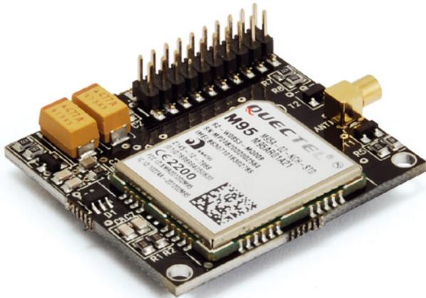
ADC (7). L'audio, facente capo a due contatti per il microfono (ad ingresso differenziale) ed altrettanti per l'altoparlante, transita dai contatti 15, 13, 9, 11, che corrispondono rispettivamente a MIC1P e MIC1N (positivo e negativo del microfono) ed SPK1N e SPK1P (rispettivamente negativo e positivo dell'altoparlante). Il segnale di RI (indicatore di arrivo chiamata) esce dal contatto 8 del connettore e viene usato per informare il microcontrollore della scheda base.
