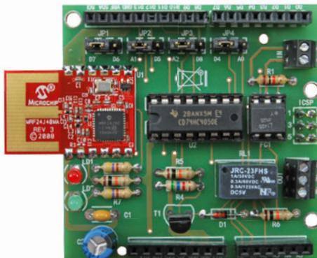
stesso (questo per avere la segnalazione visiva della presenza di comunicazione). Questo è quanto riguarda la parte radio; Per quanto riguarda l'ingresso (IN) è fotoaccoppiato mediante l'optoisolatore 4N25, il cui fototransistor di uscita risulta interdetto (quindi il collettore si trova a livello logico alto) quando all'IN manca tensione o c'è una differenza di poten-
