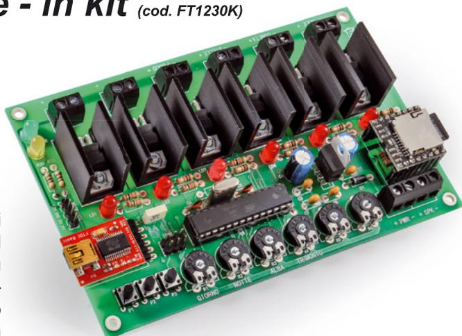
Centralina di controllo luci e sonoro per presepe. Il cui circuito è basato su un ATmega 328 (quindi l'hardware di Arduino UNO). Oltre alle luci, la scheda permette di gestire anche l'audio, grazie a un innovativo modulo riproduttore di MP3 (cod. DFR0299 - opzionale) montato sulla scheda, capace di riprodurre in altoparlante (seppure in mono) i brani contenuti in una SD-Card.
