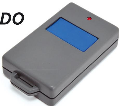
Trasmettitore palmare basato sul modulo radio LoRa SX1278 e gestito dal microcontrollore ATmega32u4. Permette di realizzare comandi via radio long-range. Il trasmettitore viene alimentato tramite una batteria a 12V tipo A23 con un consumo medio di circa 20 mA durante l'attività.
