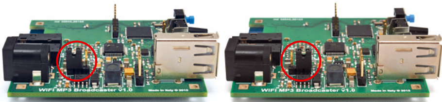
Fig. 11 - Ponendo il jumper a sinistra la scheda si alimenta direttamente a 5 V; spostandolo a destra la scheda va alimentata con 7÷15V.
