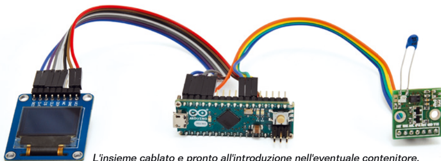
L'insieme cablato e pronto all'introduzione nell'eventuale contenitore.
