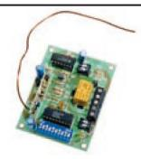
saldature con cura. Per gli integrati utilizzate gli appositi zoccoli. Come antenna è possibile impiegare uno spezzone di filo rigido lungo circa 17 centimetri. A montaggio ultimato, e prima di dare tensione, selezionate i 12 bit della codifica nello stesso modo del ricevitore e DS3 per il tipo di funzionamento. Date tensione e verificate il funzionamento del circuito facendo uso di un trasmettitore adatto.
