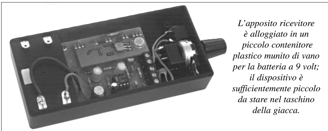
*L'apposito ricevitore è alloggiato in un piccolo contenitore plastico munito di vano per la batteria a 9 volt; il dispositivo è sufficientemente piccolo da stare nel taschino della giacca.*
