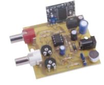
re il microfono interno e regolate il trimmer R10 per ottenere un livello ottimale dell'audio.
