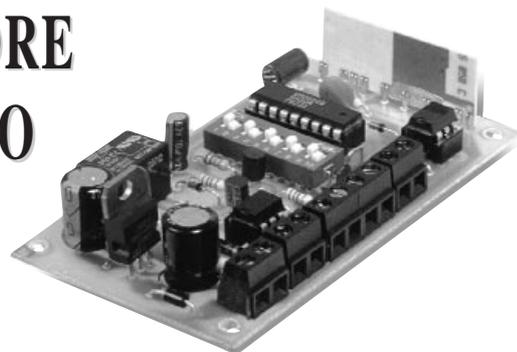
riposo il circuito consuma pochi milliamper mentre durante la trasmissione l'assorbimento complessivo raggiunge i 100 mA circa. Per incrementare la potenza RF è possibile aumentare la tensione di alimentazione fino a 15÷18 volt; in questo caso, tuttavia, è consigliabile non mantenere in trasmissione il circuito per più di 5÷10 secondi.
