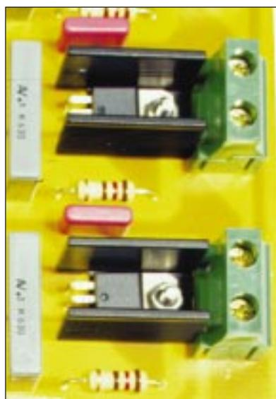
*Nell'immagine un particolare della scheda: si noti la presenza di morsettiere con passo di 10 millimetri in grado di "reggere" correnti elevate.*
