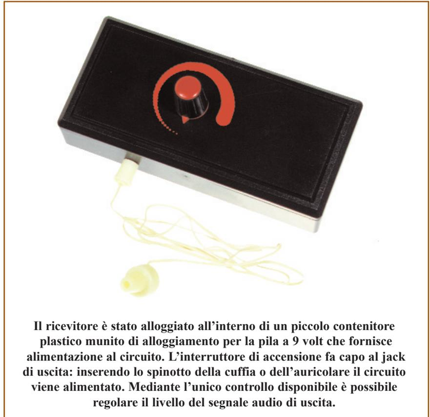
**Il ricevitore è stato alloggiato all'interno di un piccolo contenitore plastico munito di alloggiamento per la pila a 9 volt che fornisce alimentazione al circuito. L'interruttore di accensione fa capo al jack di uscita: inserendo lo spinotto della cuffia o dell'auricolare il circuito viene alimentato. Mediante l'unico controllo disponibile è possibile regolare il livello del segnale audio di uscita.**
