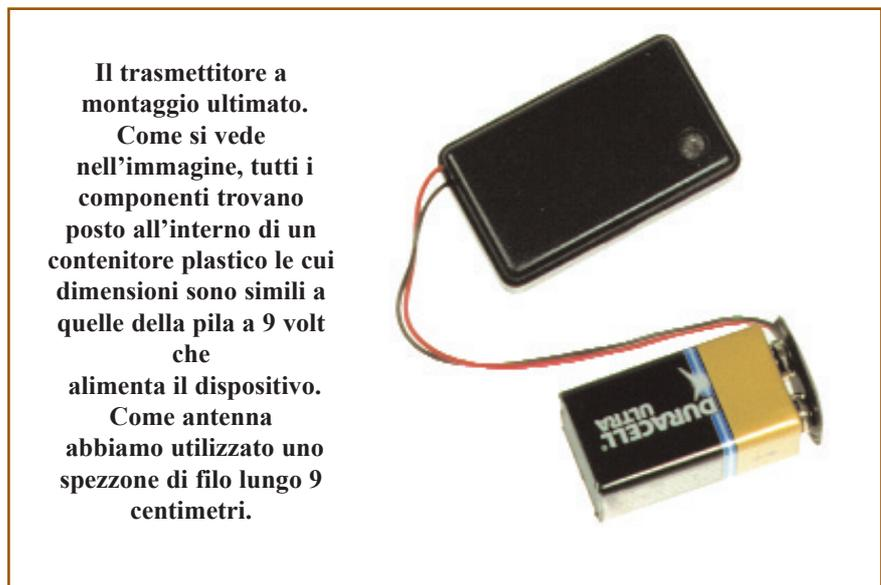
**Il trasmettitore a montaggio ultimato. Come si vede nell'immagine, tutti i componenti trovano posto all'interno di un contenitore plastico le cui dimensioni sono simili a quelle della pila a 9 volt che alimenta il dispositivo. Come antenna abbiamo utilizzato uno spezzone di filo lungo 9 centimetri.**
