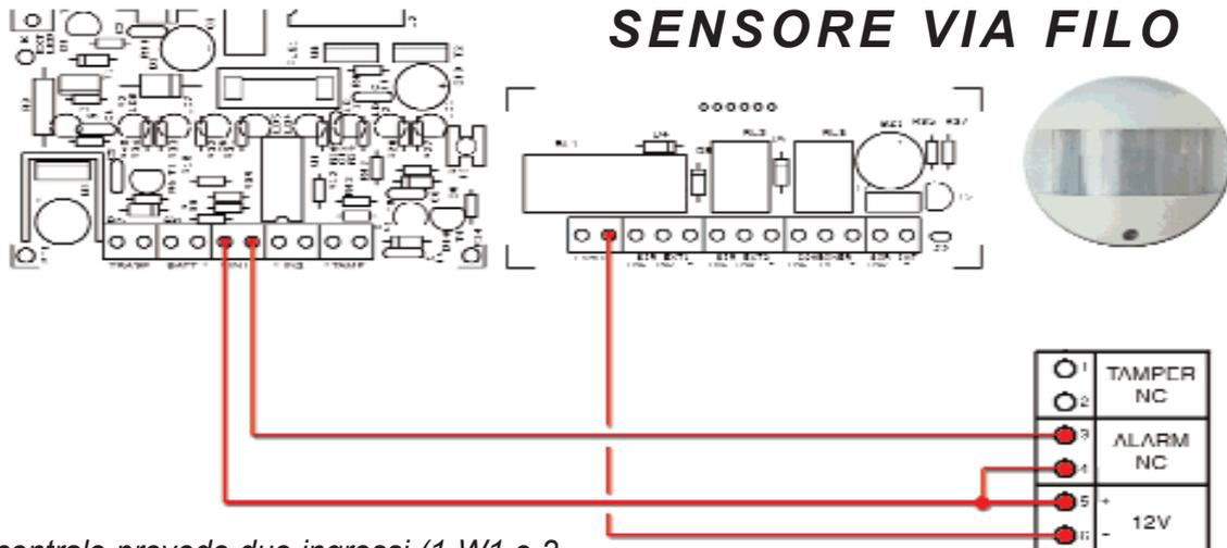
La centrale prevede due ingressi (1-W1 e 2-W1) a cui collegare sensori perimetrali o volumetrici muniti di contatto di allarme normalmente chiuso. Sopra è riportato lo schema di collegamento del sensore infrarossi via filo codice FR79. I morsetti sono siglati IN1 per la zona 1 e IN2 per la zona 2. Ad ogni singolo morsetto si possono collegare anche più sensori o più contatti posti in serie tra loro.
