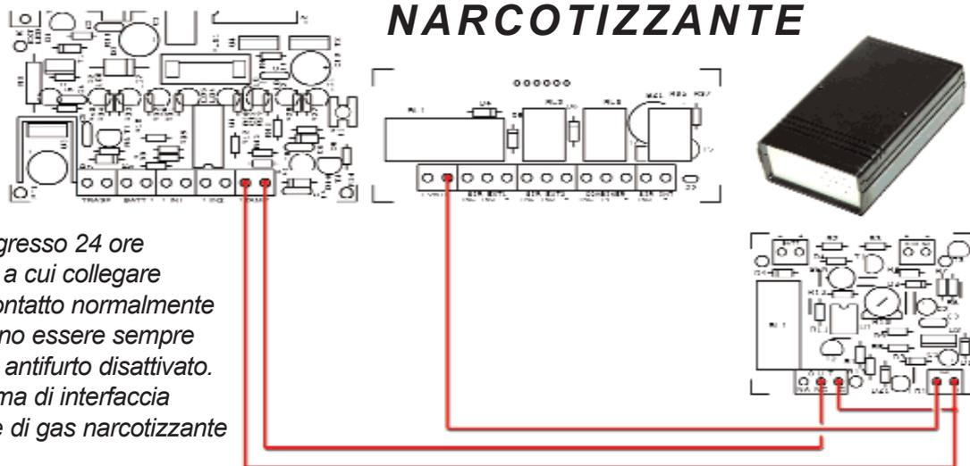
E' previsto un ingresso 24 ore (morsetti TAMP) a cui collegare dispositivi con contatto normalmente chiuso che devono essere sempre gestiti, anche ad antifurto disattivato. In figura lo schema di interfaccia verso il rilevatore di gas narcotizzante codice FT366K.
