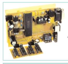
L'immagine evidenzia la scheda base della nostra demo-board la quale è fissata alla scheda di visualizzazione mediante quattro distanziali esagonali. I collegamenti elettrici tra le due piastre sono assicurati da uno strip a passo 2,54 millimetri. Nella foto si notano anche i due banchi di memoria.
