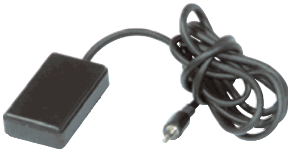
Il prototipo del sensore di movimento già inserito all'interno del contenitore plastico esterno e munito del jack di tipo stereo.
