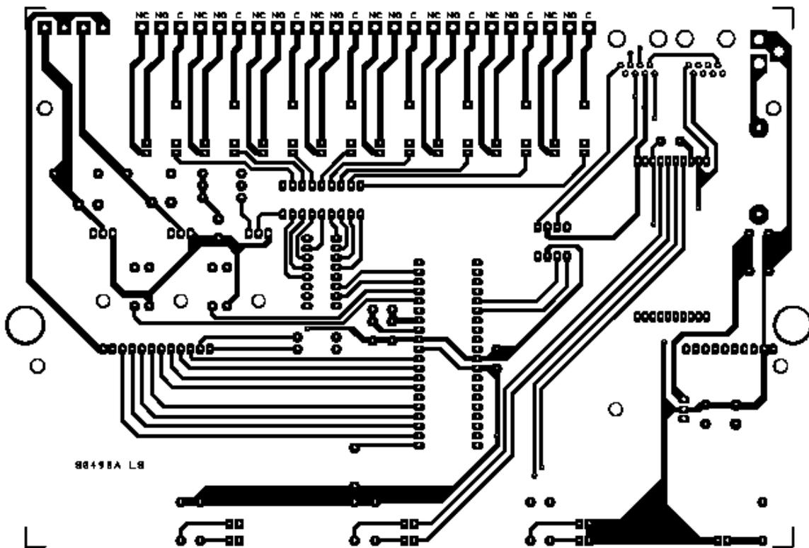
*Tracce rame del lato componenti (immagine più in alto) e del lato saldature (immagine più in basso) della basetta che realizza la scheda A. Le immagini sono state rimpicciolite; per ottenere il master in scala reale è sufficiente realizzare una fotocopia utilizzando il fattore di ingrandimento del 141%.*
