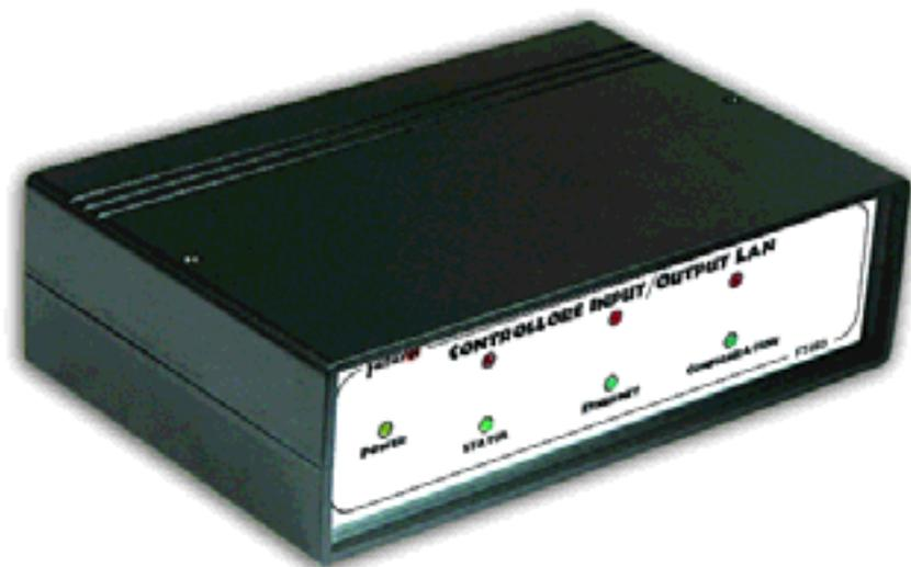
**Dispositivo di gestione di ingressi e uscite digitali o analogiche che può essere controllato tramite Internet. Ideale per applicazioni di controllo remoto di un'abitazione. Munito di un'uscita di allarme e di una porta I<sup>2</sup>C Bus utilizzabile per espandere il sistema con nuovi ingressi o uscite, sia digitali che analogiche.**
