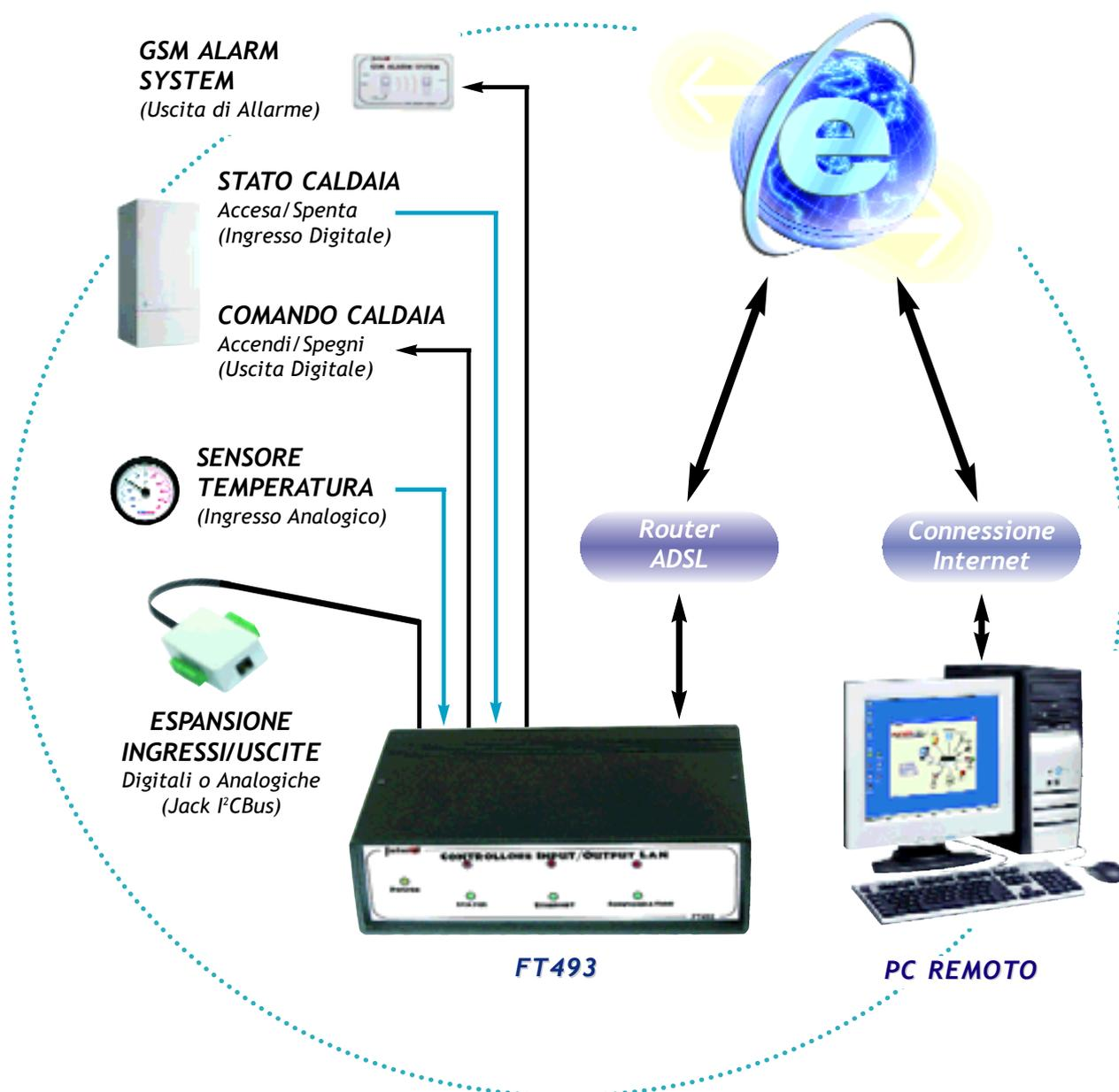
presentiamo invece un nuovo progetto più complesso e caratterizzato da un utilizzo finale più generale. Scopo del nuovo sistema è quello di rendere disponibili una serie di ingressi e uscite sia digitali che analogiche che, utilizzando il modulo ethernet EM100, saranno raggiungibili da qualsiasi PC connesso a internet. In particolare nel circuito
