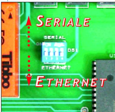
Il circuito può essere collegato a un PC sia mediante una connessione Ethernet basata sul protocollo TCP/IP, sia mediante una connessione seriale RS232. In entrambi i casi viene utilizzato il jack ethernet/seriale in formato RJ45 presente nel circuito; quindi se si utilizza una connessione LAN il cavo proveniente dalla rete andrà collegato direttamente al connettore RJ45; se invece si sceglie di utilizzare una connessione seriale sarà necessario utilizzare un opportuno
