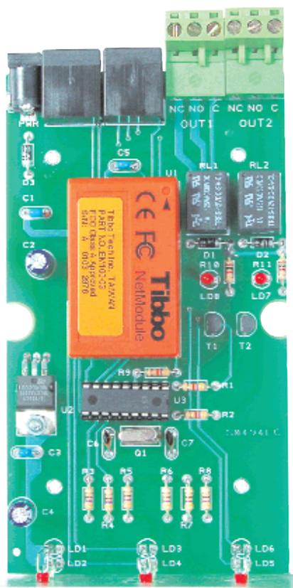
tre diverse modalità: *Normal mode* nella quale realizza la conversione Ethernet/seriale; *Serial programming mode* utilizzata per programmarlo e *Firmware download mode* utilizzata per l'upgrade del firmware presente nel modulo. La selezione della modalità di funzionamento avviene tramite i due piedini appena indicati; nel nostro circuito si utilizza la prima modalità la cui selezione viene gestita automaticamente dal software presente nel microcontrollore.
