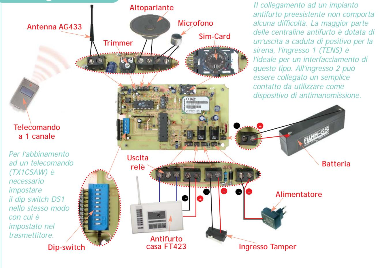
sibile comandare l'attivazione dell'ampli utilizzando il transistor PNP T4 montato sulla linea di alimentazione. L'ultima sezione del circuito fa capo al modulo GSM GM47 che si occupa dell'inoltro delle chiamate agli utenti memorizzati. Il modulo è controllato direttamente dal microcontrollore mediante comandi AT che utilizzano la
