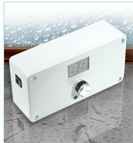
visualizza due zeri lampeggianti. A questo punto rilasciate il pulsante e, utilizzando il potenziometro R1, impostate la soglia da 1 Km/h a 70 Km/h. Il valore prescelto viene visualizzato direttamente sul dis-
