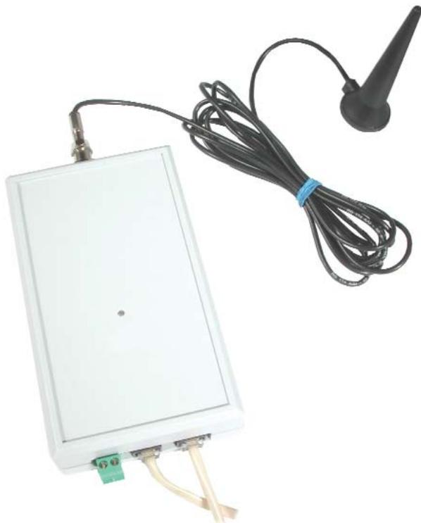
Alzando la cornetta il led diventa immediatamente rosso mentre lampeggia lentamente con luce arancione quando è in corso una chiamata GSM. Per alimentare il circuito è necessario impiegare un alimentatore in
