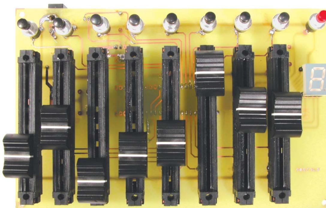
*Il controller DMX utilizza un circuito stampato a doppia faccia; i componenti sono montati sia da un lato che dall'altro in modo da rendere più agevole la realizzazione del dispositivo dal punto di vista meccanico. Infatti i comandi (sliders e pulsanti) sono fissati direttamente al c.s anziché al pannello frontale.*
