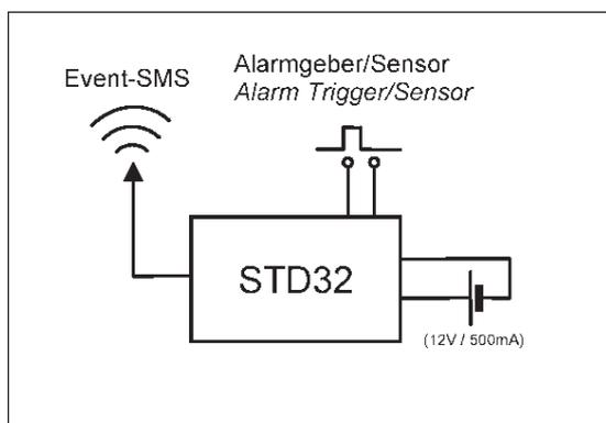
Consente di ricevere un SMS di allarme sul proprio cellulare quando su uno degli ingressi viene applicata una tensione di 12Vdc (dovuta, ad esempio, all'entrata in funzione del sistema di allarme, all'attivazione di un sensore ad infrarossi o di un sensore di temperatura, ecc.)
