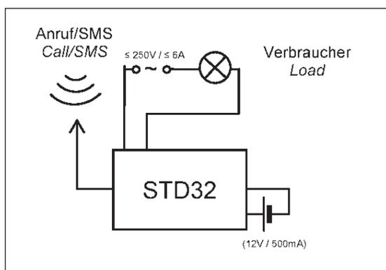
E' sufficiente, con un cellulare abilitato, effettuare una chiamata o inviare un SMS per attivare o disattivare qualsiasi carico fino a a 250V / 6A (ad esempio, sistemi di riscaldamento, condizionamento, impianti antifurto, elettroserrature, appiccandole, ecc.)
