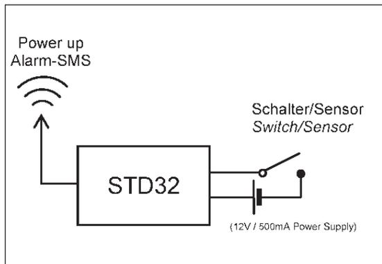
E' sufficiente che il dispositivo venga connesso ad una sorgente di alimentazione a 12 volt per ricevere, sul vostro cellulare e dopo l'entrata in rete dell'teso32, il messaggio di Start Up (il comando di accensione può essere costituito, ad esempio, da un interruttore magnetico montato su una porta o da qualsiasi altro sensore).
