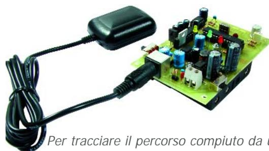
*Per tracciare il percorso compiuto da un'automobile, si può pensare di collocare il localizzatore nel bagagliaio, facendo passare dietro la tappezzeria i cavi per l'alimentazione e il ricevitore GPS; quest'ultimo va posizionata a ridosso di uno dei vetri. Conviene inserire il circuito in un contenitore che lo protegga dagli urti.*
