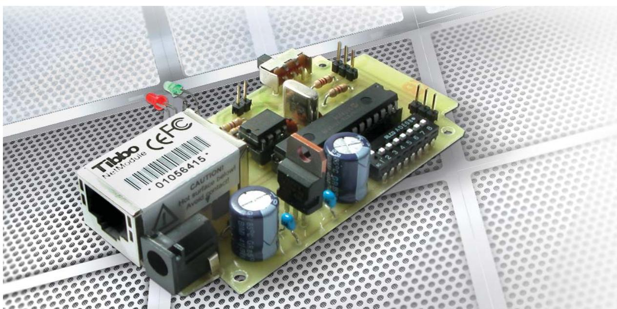
Unità capace di sfruttare la rete LAN usata dai computer per far transitare i dati del protocollo DMX512; si tratta di un'interfaccia che consente alla console, di raggiungere i gruppi di controllo delle luci senza bisogno di uno specifico cablaggio.
