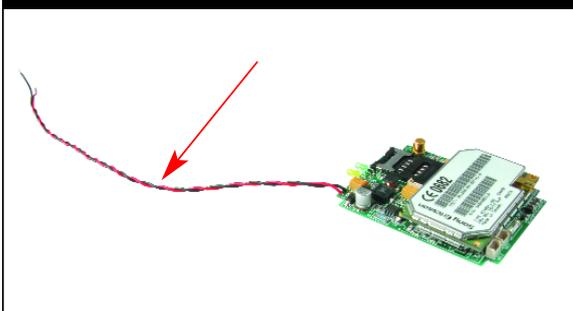
Coppia di cavetti utilizzati per l'alimentazione del dispositivo (rosso +, nero -). Il valore di tensione deve essere compreso tra 5 e 32 Vcc; l'assorbimento è di 20 mA a riposo, e di circa 300 mA in trasmissione.
