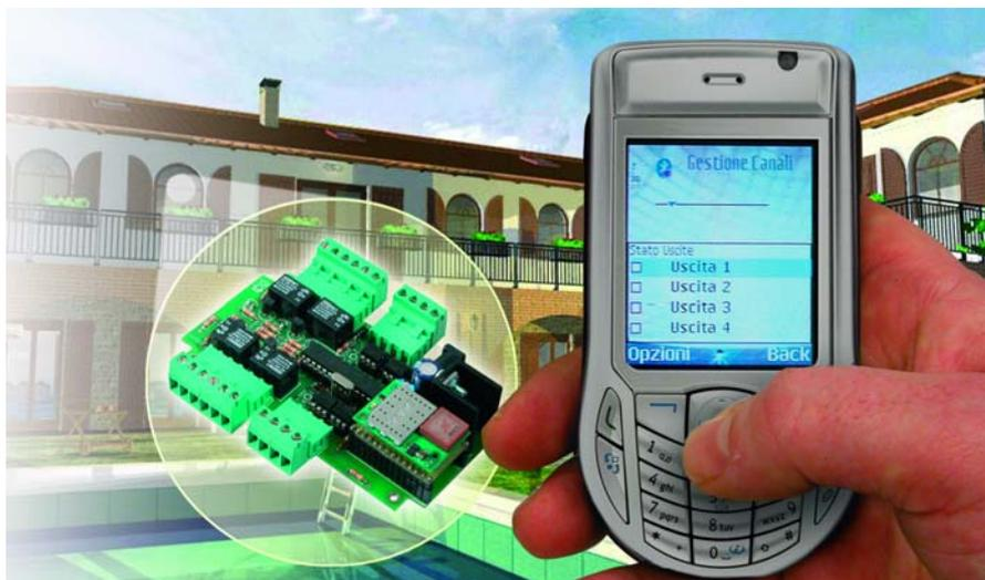
**Semiautomatica:** è simile alla precedente, ma differisce per il fatto che la prossimità di un cellulare (o altro dispositivo) Bluetooth non attiva direttamente un determinato relé, ma dà il consenso per il comando diretto di RL1, RL2, RL3, RL4 mediante un livello di tensione applicato agli input: la presenza di tensione ad un ingresso determina l'attivazione dell'uscita corrispondente (l'input 1 agisce su RL1, il 2 su RL2 e via di seguito).
