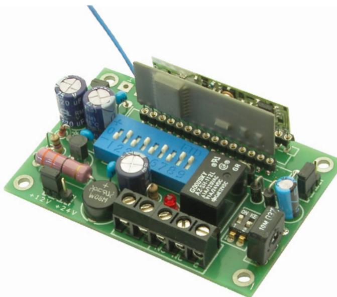
zione della modalità di funzionamento si esegue semplicemente agendo su di un dip-switch a 2 vie. Grazie al raddrizzatore integrato il circuito può essere alimentato con tensione sia continua che alternata permettendo maggior flessibilità nell'installazione in impianti già esistenti (quali apricancello, antifurto e simili). Il ricevitore dispone di un selettore che consente all'utente di impostare la tensione di alimentazione che può essere pari a 12 o 24 Vdc o ac.
