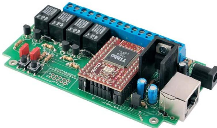
a molteplici applicazioni: può rilevare e segnalare lo stato di allarme di alcuni sensori come, ad esempio, fuoco, acqua, intrusione, così come può gestire, attraverso semplici comandi, quattro carichi dif ferenti per
