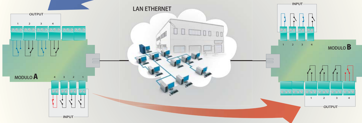
Fig. 1 - Il dispositivo può funzionare in modalità stand-alone: collegando su Ethernet una coppia di unità, lo stato dei relé dell'una ripete quello degli input dell'altra (input aperto=relé a riposo; input chiuso=relé eccitato).
