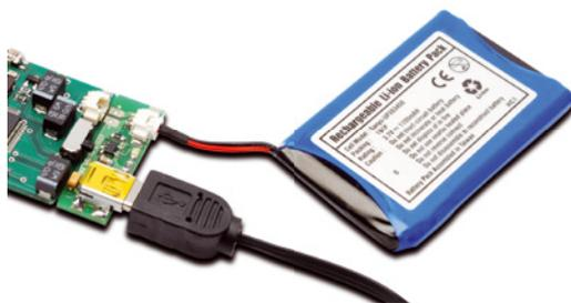
**Fig. 4** - Dispositivo alimentato da una sorgente esterna (5Vdc) completo di circuito per la ricarica della batteria.
