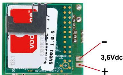
**Fig. 3** - Polarità piazzole per alimentazione mediante modulo switching.
