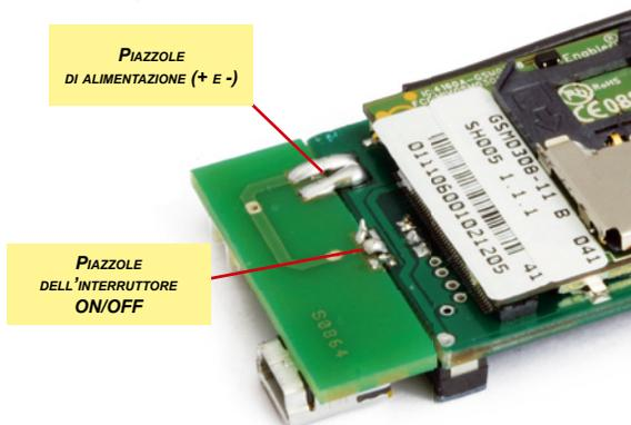
**Fig. 2** - Il collegamento del modulo di ricarica al dispositivo si esegue unendo mediante saldatura le piazzole di alimentazione e quelle dell'interruttore ON/OFF.
