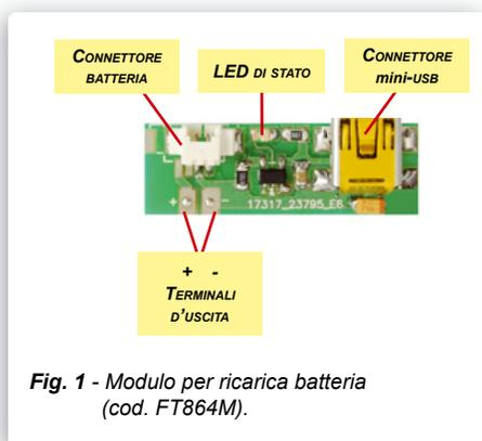
Fig. 1 - Modulo per ricarica batteria (cod. FT864M).
