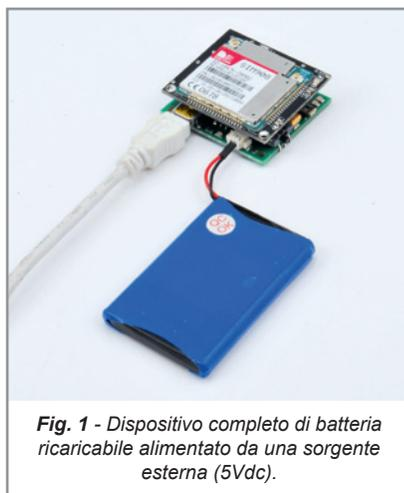
*Fig. 1 - Dispositivo completo di batteria ricaricabile alimentato da una sorgente esterna (5Vdc).*
