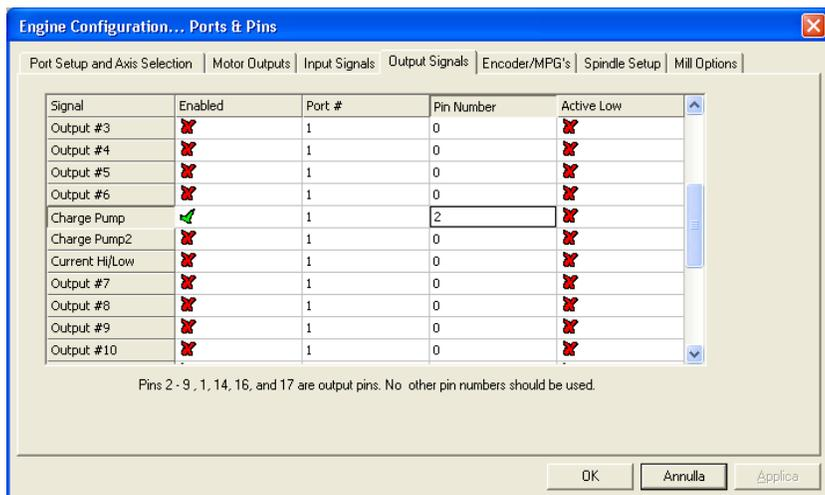
Se si desidera attivare ad esempio una pompa, spuntare la voce “Charge Pump”, impostare “1” nelle relative caselle “Port#” e specificare il corrispondente Pin Number (2). Terminate le configurazioni premere OK.
