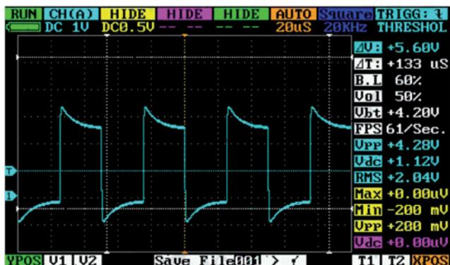
**Figura 1.** Forma d'onda che indica la necessità di eseguire la calibrazione
