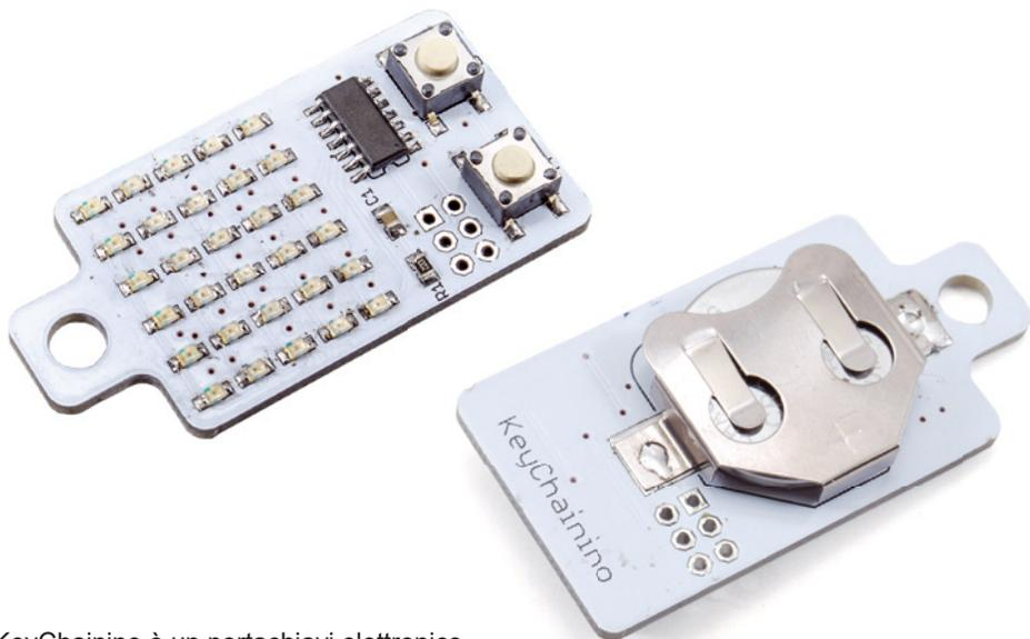
KeyChainino è un portachiavi elettronico programmabile con Arduino. È composto da una matrice di 6x5 LED in SMD e due pulsanti, il tutto controllato dal piccolo ATTiny84A, un microcontrollore Atmel ad 8 bit in SMD. KeyChainino si programma con Arduino UNO tramite il connettore ICSP (vedi schema sul retro), mentre l'alimentazione è fornita da una batteria CR2032.
