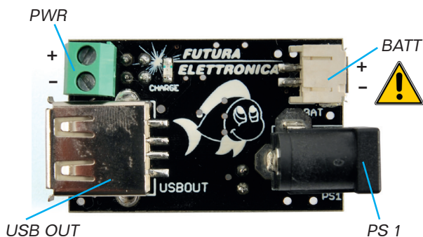
Fig. 1 - Connessioni dell'alimentatore: PWR è l'uscita, BATT l'attacco per la batteria, PS1 l'alimentazione principale e USB IN l'ingresso d'alimentazione da USB.
