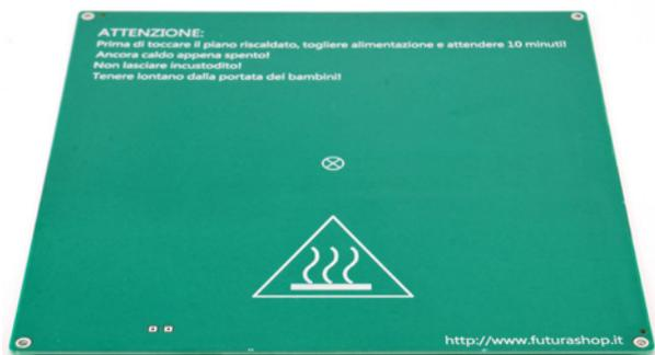
Piatto riscaldato in vetronite in grado di raggiungere una temperatura di 90°C. Si alimenta tramite l'apposita scheda che gestisce la stampante e assorbe circa 7 A. La resistenza della scheda è circa 1,6 ohm. Dimensioni: 21x21 cm, dimensioni area di stampa: 19 x 18,7.
