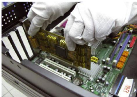
Nota: adottare misure antistatiche. Assicurarsi che i contatti a pettine della scheda siano ben inseriti nello slot. Fissare il pannello posteriore con le apposite viti.
