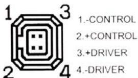
L'obiettivo dispone di un controllo dell'apertura del diaframma auto-iris di tipo Driver DC con connettore a 4 poli. In questo caso tutti i costruttori di telecamere utilizzano la configurazione standard riportata a lato (il disegno si riferisce ad una presa).
