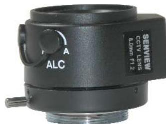
L'obiettivo dispone di un controllo dell'apertura del diaframma auto-iris di tipo Video Drive; il relativo cavo a tre poli va saldato ad un connettore IRIS a 4 pin seguendo le specifiche fornite dal costruttore della telecamera. Ricordiamo che in questo caso non esiste uno standard univoco.
