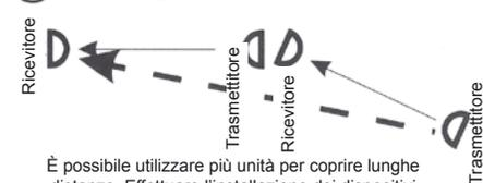
È possibile utilizzare più unità per coprire lunghe distanze. Effettuare l'installazione dei dispositivi seguendo lo schema sotto riportato per evitare problemi di interferenza tra i fasci.
