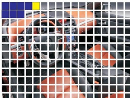
Spostarsi tramite i tasti  $\blacktriangleleft$ / $\blacktriangleright$  a destra o a sinistra e selezionare l'area che non deve essere rilevata. Le parti della griglia selezionate appariranno inizialmente in giallo; risulteranno di colore blu una volta che verranno confermate con il tasto “OK”. Le zone di colore blu non verranno rilevate, mentre le altre sì.
