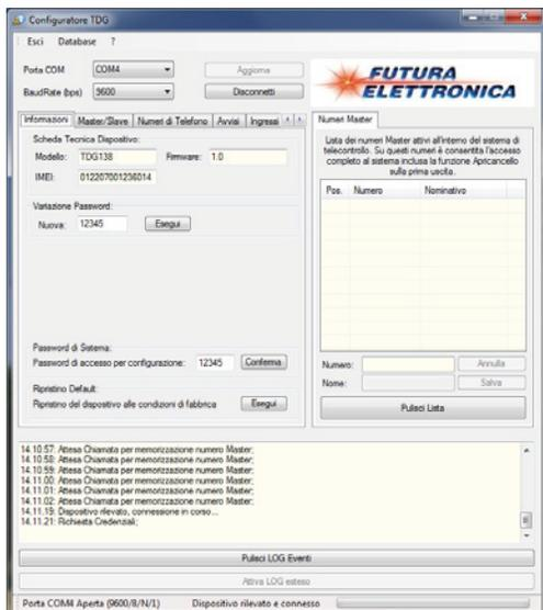
La finestra Master/Slave consente di impostare il tipo di dispositivo (Master o Slave), le tempistiche di chiamata relative alla modalità di funzionamento anti-jammer e il tempo di attivazione dell'uscita 1 in caso di allarme.
