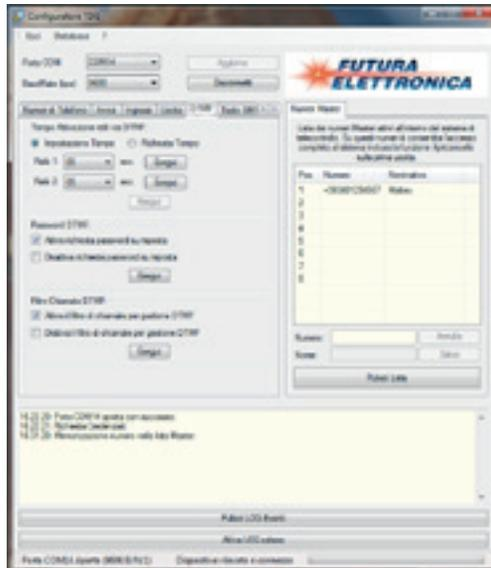
I testi degli SMS d'avviso, inviati dal dispositivo a seguito di una variazione di stato degli ingressi o di blackout, possono essere definiti dall'utente tramite la finestra "Testo SMS".
