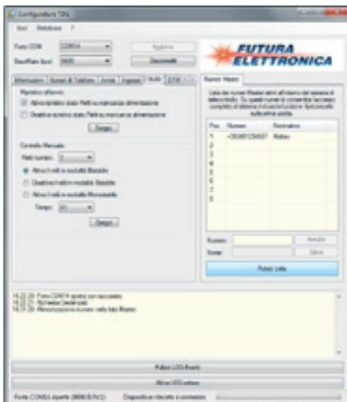
I parametri relativi alla gestione tramite DTMF (tempi di attivazione relé, richiesta Password DTMF, attivazione/disattivazione filtro chiamate) possono essere definiti tramite la cartella “DTMF”.
