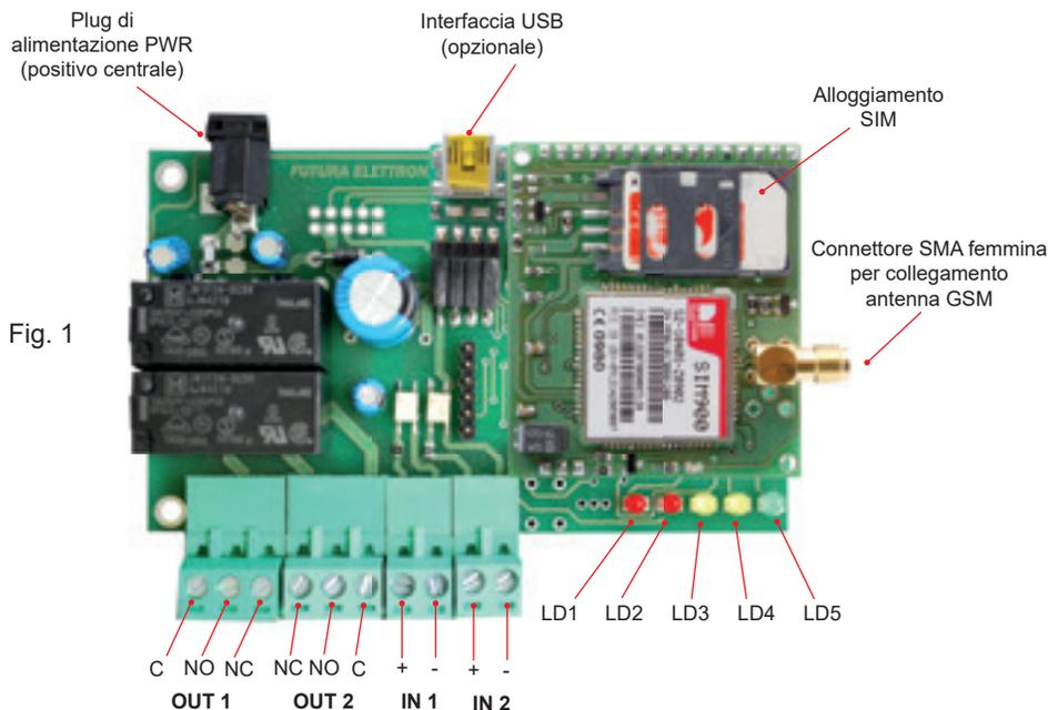
Quando il dispositivo è in fase di ricerca della rete GSM, il led contraddistinto dalla sigla "LD5" lampeggia con una frequenza di 1 Hz, mentre quando è agganciato alla rete, emette un breve lampeggio ogni 2 secondi; rimane acceso fisso solamente nel momento in cui il modulo riceve una chiamata. I led LD1 e LD2 segnalano lo stato dei relé mentre LD3 e LD4 indicano lo stato degli ingressi:
