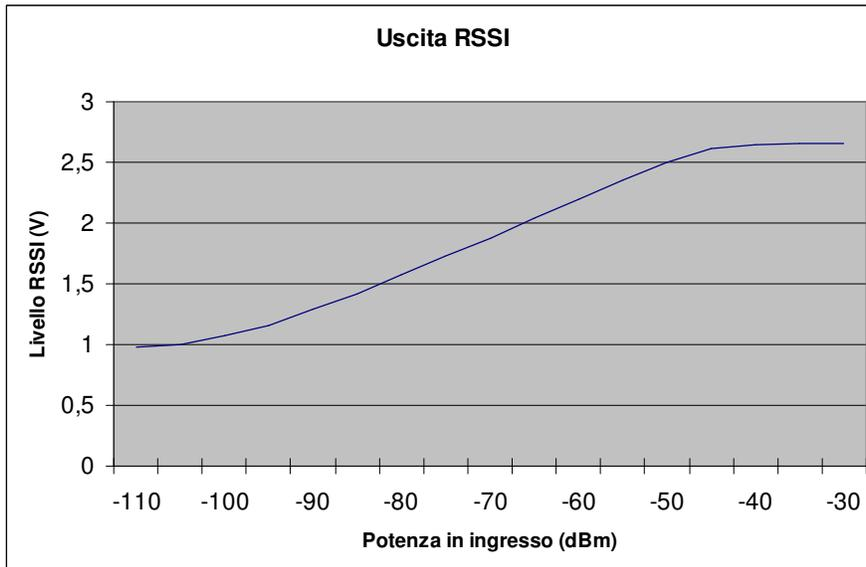
**Fig.3 : uscita RSSI con basso guadagno (pin 11 collegato a +V)**
