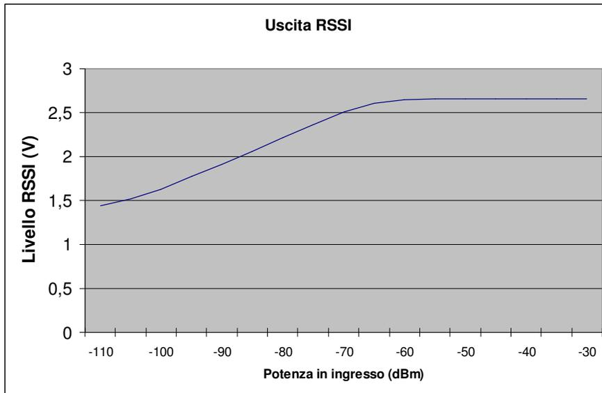
**Fig.2 : uscita RSSI con alto guadagno (pin 11 collegato a GND)**
